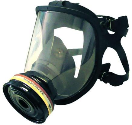
Лицевая часть бывает трех ростов (1,2,3). Для подбора лицевой части необходимо определить замер вертикального (замкнутая линия, проходящая через макушку, щеки и подбородок) и горизонтального (замкнутая линия, проходящая через лоб, виски и затылок) обхвата головы. Результаты округляют до 0,5 см.
